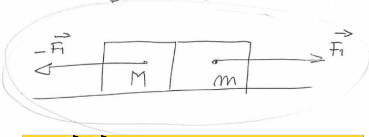
$\vec{F}_1$  e  $-\vec{F}_1$  sono una coppia di forze di azione-reazione di tipo impulsivo che agiscono in un tempo infinitesimo  $[t_u; t_u + dt]$  ( $t_u$ : istante dell'urto,  $dt$ : durata dell'urto)
