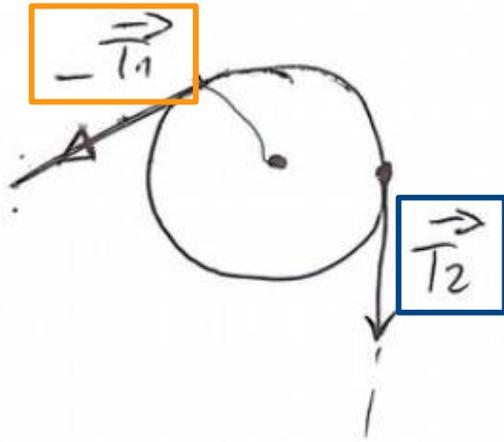
$$\vec{T}_2 = T_2 \begin{bmatrix} 0 \\ -1 \end{bmatrix} \quad T_2 > 0$$
