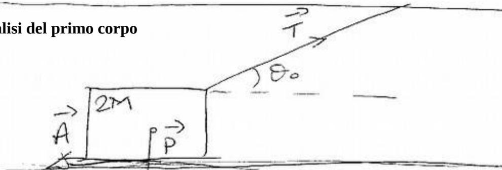
$$\vec{P} = \begin{bmatrix} 0 \\ -2Mg \end{bmatrix} \quad \vec{N} = \begin{bmatrix} 0 \\ N \end{bmatrix} \quad \vec{T} = \begin{bmatrix} T \cos \theta_0 \\ T \sin \theta_0 \end{bmatrix}$$
