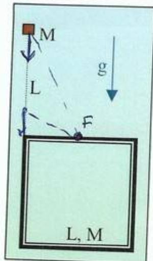
Una cornice quadrata avente per lati quattro sbarrette omogenee identiche di lunghezza  $L$  e massa  $M$ , è sospesa ad un punto situato sul centro di un suo lato. Una particella di massa  $M$  (uguale a quella di ogni lato) cade da un'altezza  $L$  e urta elasticamente, da sopra, un angolo della cornice (vedi figura).
