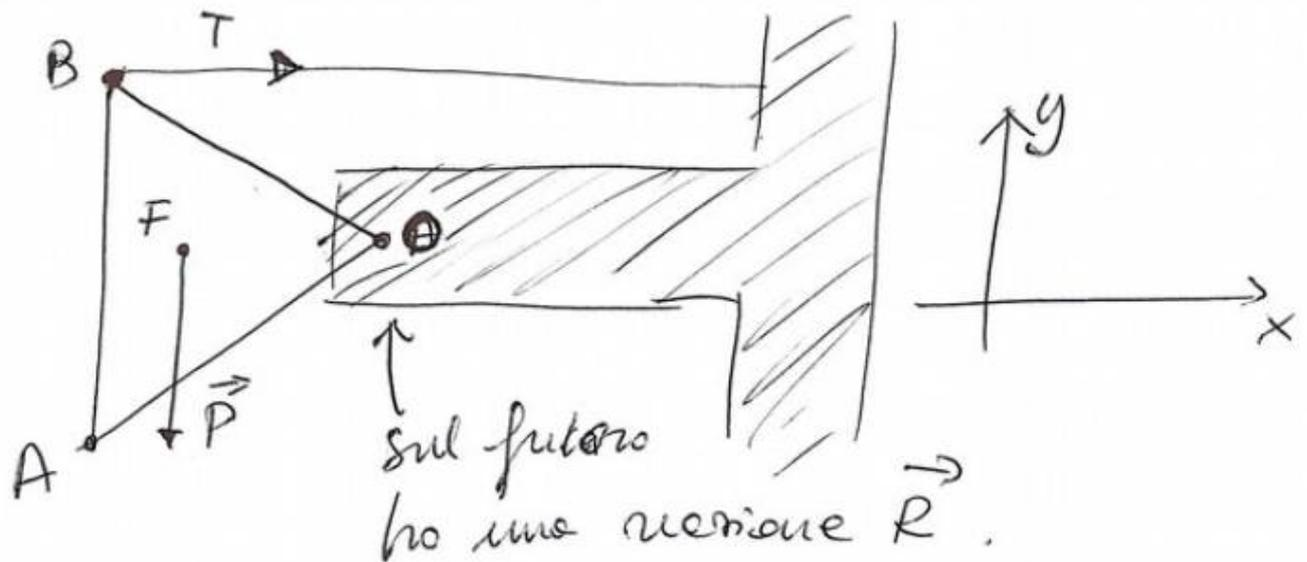
$$\vec{T} = \begin{bmatrix} T_x \\ 0 \end{bmatrix} \quad \vec{P} = \begin{bmatrix} 0 \\ -Mg \end{bmatrix} \quad \vec{R} = \begin{bmatrix} R_x \\ R_y \end{bmatrix}$$
