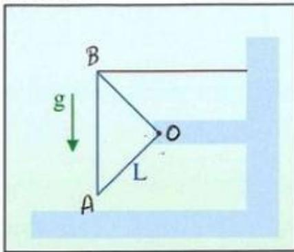
Si ha una cornice a forma di triangolo rettangolo isoscele. I lati uguali hanno lunghezza  $L$ , e tutti i lati hanno densità lineare di massa  $\lambda$ . La cornice è impernata sull'angolo retto ad un asse orizzontale. Perciò essa ruoterebbe su un piano verticale, se non fosse tenuta in posizione da una corda ideale (inestensibile e di massa trascurabile) applicata come in figura e disposta orizzontalmente.
